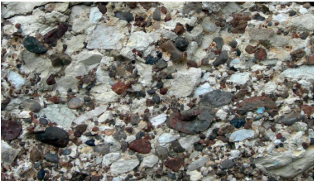
**Fig. 5** - Roccia composta da frammenti (clasti) di rocce preesistenti. Quelli scuri sono a composizione silicea (selce), mentre quelli chiari sono a composizione carbonatica. La roccia è cementata e la matrice è molto scarsa, tanto che i clasti sono a contatto tra loro.
